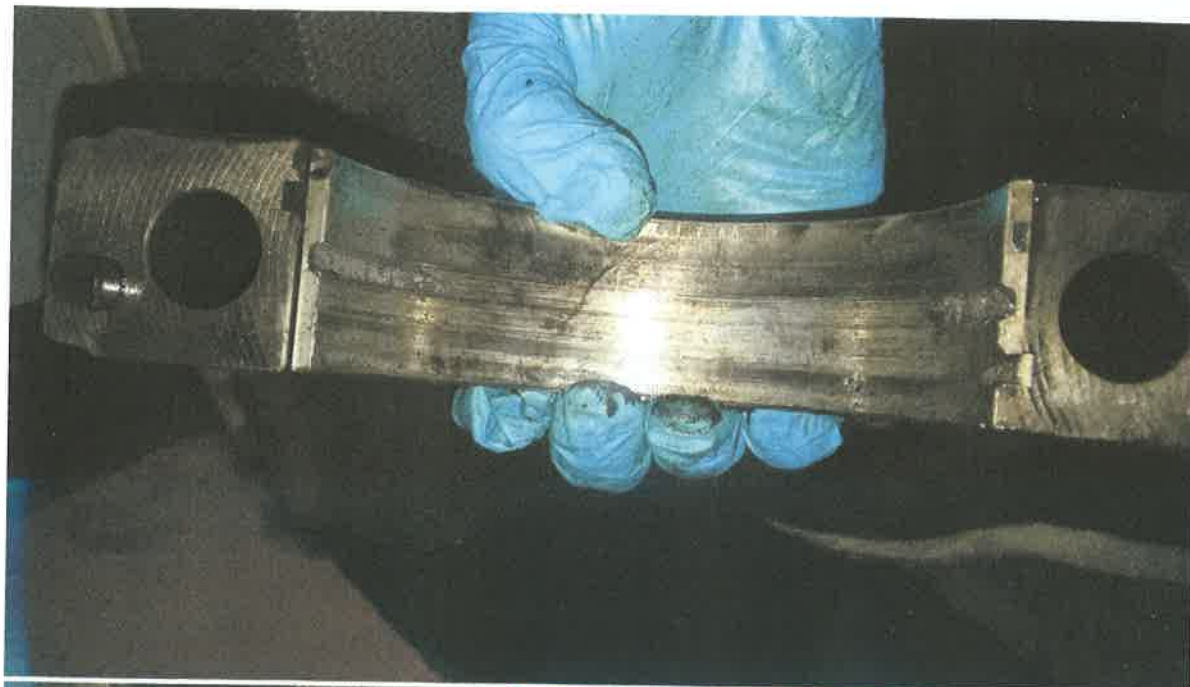
Zatarte Panewki główne wału korbowego
