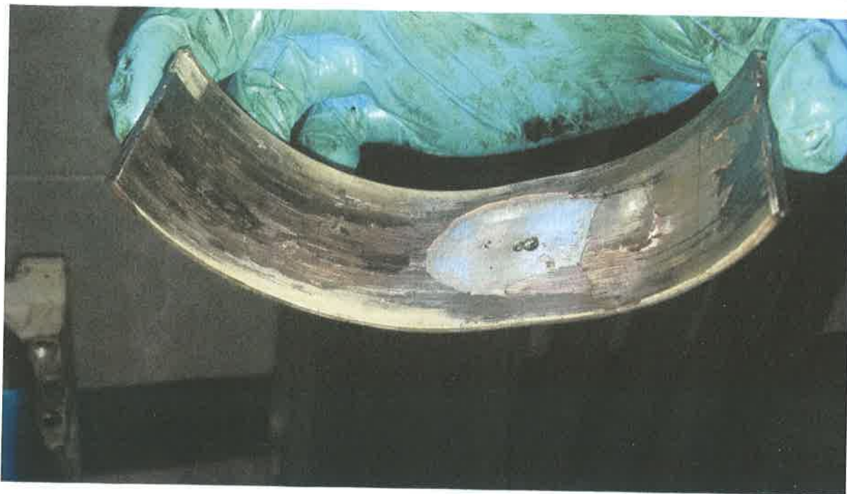
Rysy i fragmenty panewek zgrzane na czopach korby wału
