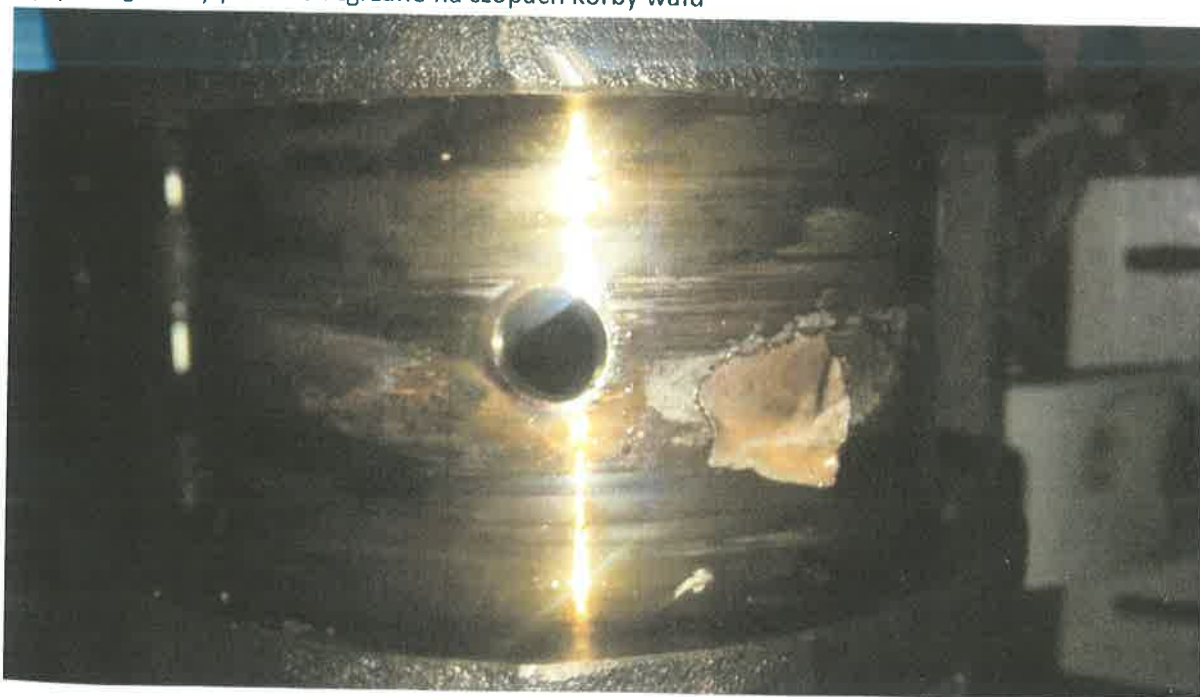
Rysy i fragmenty panewek zgrzane na czopach korby wału
