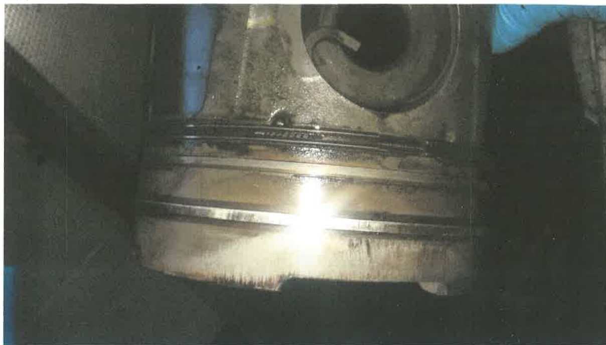
Rysy Na powierzchniach walcowych tłoka
